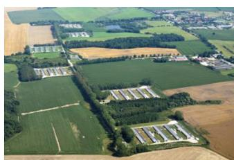
Die Anlage hat ihren Standort in Groß-Stieten, etwa 10km südlich von Wismar (Mecklenburg-Vorpommern) und hat eine Größe von 1,4 MWp. Die Aufdachanlage ging im Dezember 2008 vollständig ans Netz. Es wurden beim Bau First Solar Module sowie Wechselrichter von SMA verwendet. Die Anlage erhält eine Einspeisevergütung von EUR 460/MWh. Der Park leistete 836 kWh/kWp in den letzten 12 Monaten vor dem Unternehmenszusammenschluss.
