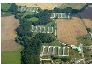
Im Dezember 2008 wurde eine Dachanlage über 0,857 MWp in Neubukow, Deutschland in Betrieb genommen. Es wurden beim Bau First Solar Module sowie Wechselrichter von SMA verwendet. Die Anlage erhält eine Einspeisevergütung von EUR 461/MWh.
