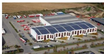
Die Anlage hat ihren Standort in Opglabbeek, Belgien und hat eine Größe von 0,4 MWp. Die Dachanlage ging im Juni 2011 ans Netz. Es wurden beim Bau Solarfun Module verwendet und Wechselrichter von SMA. Die Anlage erhält eine Einspeisevergütung von EUR 330/MWh. Der Park leistete 889 kWh/kWp in den letzten 12 Monaten vor dem Unternehmenszusammenschluss.
